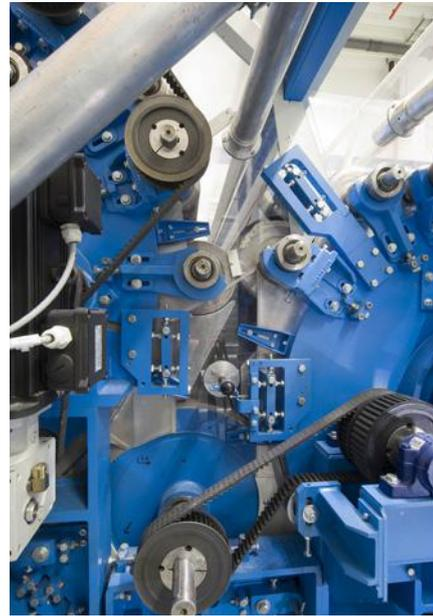
Tutte le macchine hanno sistema salvarolle sui cilindri lavoratori, volteggiatori, pettinatori e trasportatori. Tutti i tamburi hanno sistema di ventilazione per evitare l'inserimento di fibra tra cilindro e mezzaluna. Disponibilità di salvataggio ricette e a richiesta collegamento a supervisor aziendali o interventi via modem.
